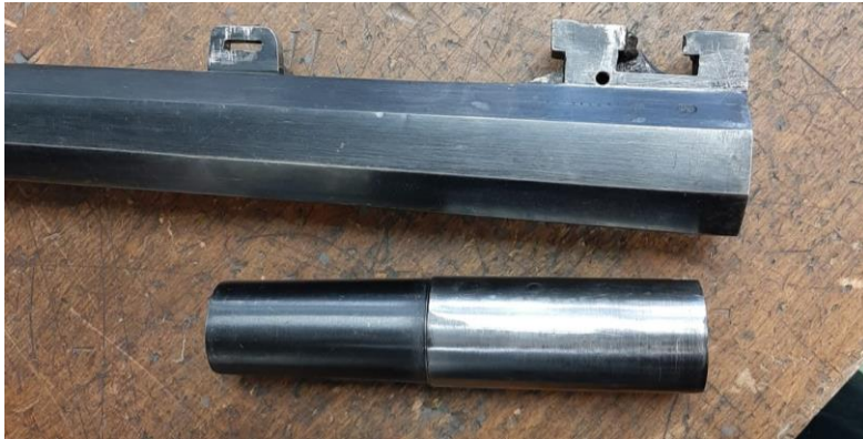
Abbildung 2 Gewehrlauf und Einstecklauf
